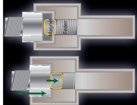
Der freischwebende Magnet senkt sich nach Schraubenkontakt und hält sie fest. Der Schraubenkopf liegt auf der Bohrung des Steckschlüssels und nicht auf dem Magnet.
